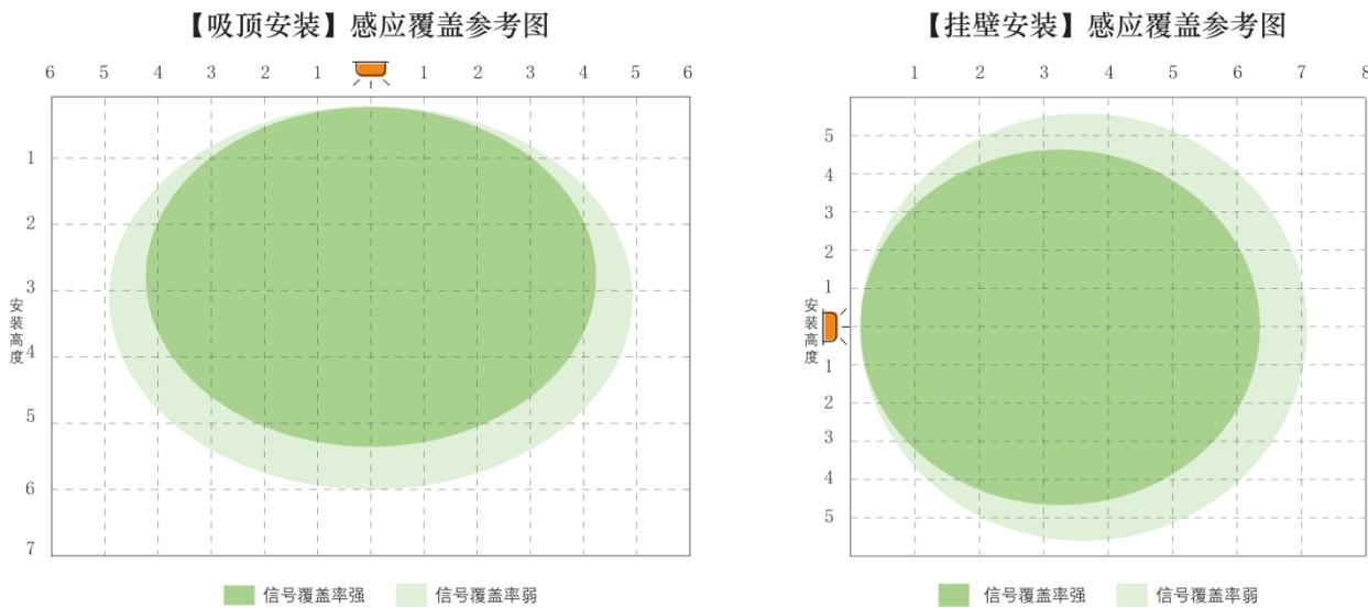
**注：**整机产品在实验室中按装测试出数据。（实际应用中吸顶安装或者挂壁安装，会因为结构件、电磁波等外围影响导致距离有偏差）。
